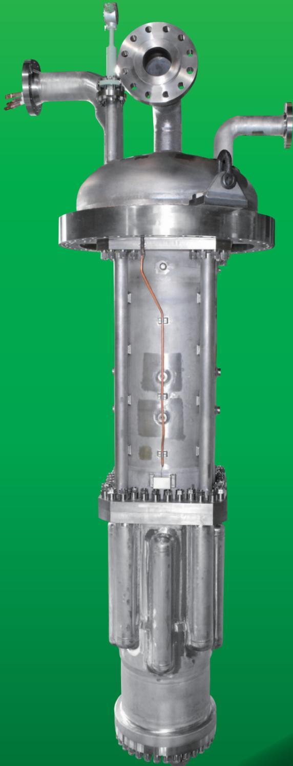
シンコーSMBバレル型ポンプは、LNG、LPG又はDME貯蔵基地における払出ポンプ、冷熱発電プラントの加圧並に循環ポンプとして開発されたものであります。ポンプは貯蔵タンクの外部に設置されるバレル内の超低温液化ガス中に潜没して使用され、保守又は点検の必要が生じた場合には、タンクとバレルの間に設けられたバルブを閉め、容易にバレルの外に取出すことのできる構造になっています。
